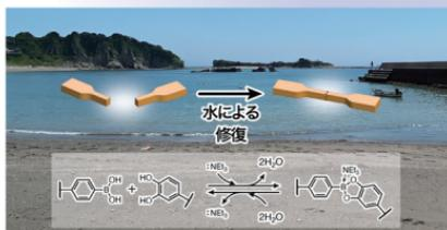
地球上のあらゆるところにある水の作用で修復するポリマーを開発しました。海水中では液体の水を、空気中では水蒸気をわずかに吸収して、ポリマー中に組み込んだボロン酸エステルと協働して、ひとりでに切断面がくっつきます。
