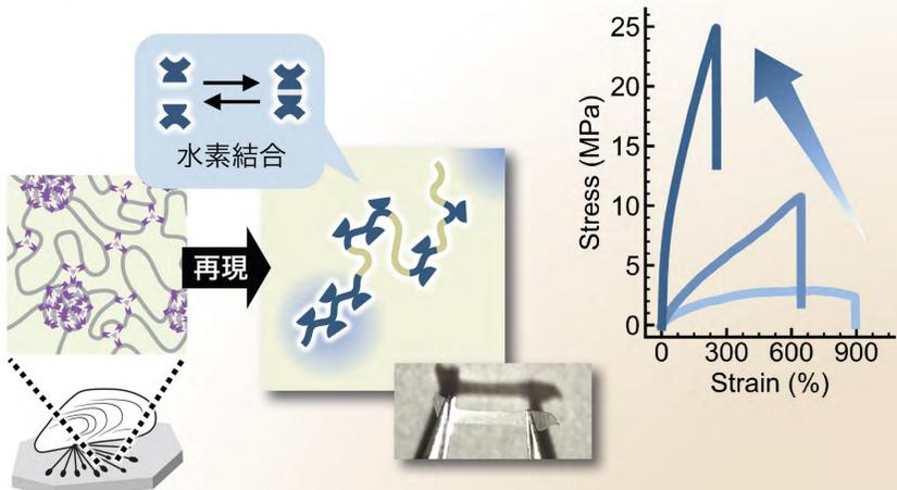
イガイ(ムール貝)は、その身体を岩に固定するために強靱な足糸を持っています。このような生体組織に共通して存在する、動的結合による多相構造を人工ポリマー材料中に再現することで、タフなポリマー材料を開発しました。
