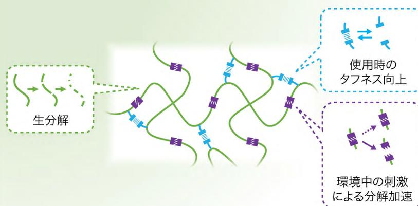
廃プラスチックの地球環境への影響が問題視されるようになり、自然環境中で分解するポリマー材料が求められています。私たちは、使用時には十分なタフネスを示しつつ、自然環境中の外部刺激によって加速的に分解するポリマーを開発しています。
