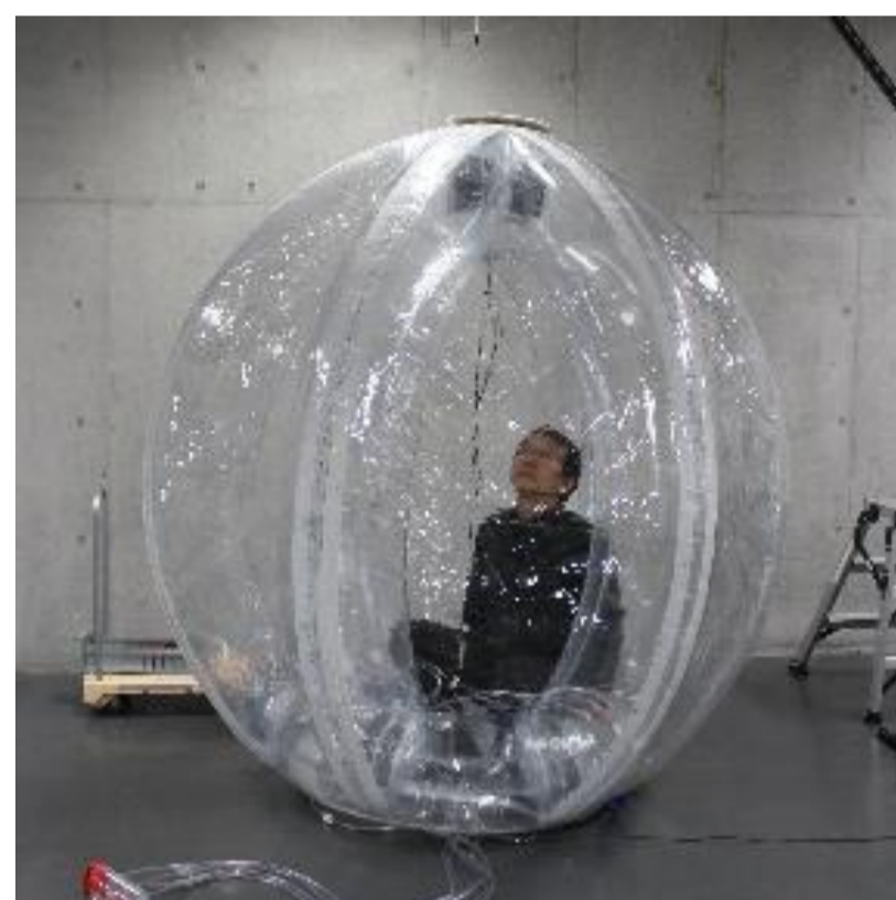
図 充填式空気膜構造による個人用津波シェルター (球形の外膜と円環型のアチュープによって構成, 猪口2019)から抜粋)
