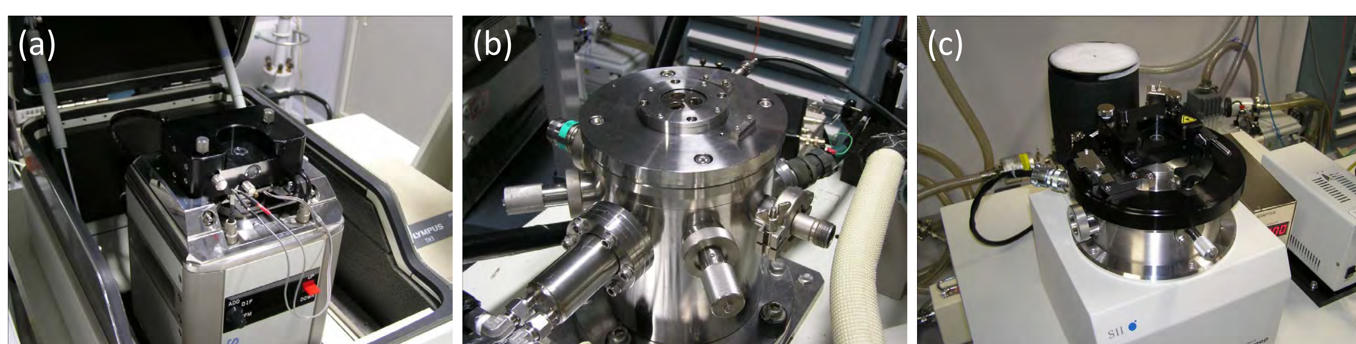
多機能SPMユニット: (a) 大気型, (b)(c) 温度可変超高真空型
